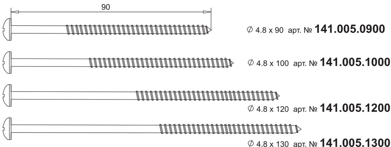
соединительные шурупы оцинкованные, с желтым хромированием, для крестовой насадки Philips № 2
