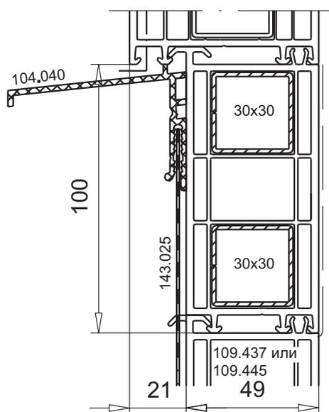
расширительный профиль для балконной двери арт.№ **109.437**
