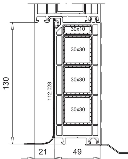
расширительный профиль для балконной двери арт.№ **109.569**
