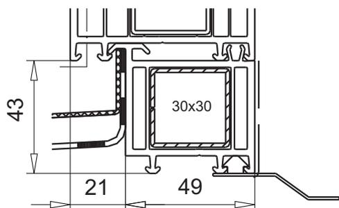
расширительный профиль для балконной двери арт.№ **109.445**
